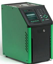
Bloque seco de temperatura portátil Beamex, que ofrece una exactitud a nivel de baño para aplicaciones industriales exigentes • Incorpora entrada para sonda de referencia de gran exactitud (en el modelo R) • Profundidad de inmersión de hasta 200 mm • Rango de temperatura a +35 °C a +425 °C • Certificado de calibración
