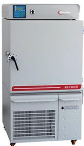
Equipos de alta gama fabricados con elevadas exigencias metrologías. Amplio rango de trabajo: Estándar (+5 °C a +180 °C), Baja temperatura (-40 °C a +180 °C) y Ultra baja temperatura (-75 °C a +180 °C). Humedad standard 10% -98%.
