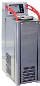
Micro baños de calibración de baja temperatura portátiles OBM y OBM-LT de Kambic • Se configuran mediante una pantalla táctil con una interfaz de usuario fácil de usar, permiten la visualización de gráficos históricos y configuraciones avanzadas • Cuenta con agarraderas en la parte superior para un mejor manejo y portabilidad, cada agarradera tiene orificios para colocar cables y sensores.
