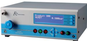
Equipo multifunción para la detección avanzada de fugas por caída de presión
