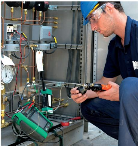
Gometrics dispone de un equipo de profesionales para realizar trabajos de calibración y caracterizaciones térmicas *in situ*. Nuestro personal se traslada con los patrones de calibración al emplazamiento del cliente para ejecutar las tareas de recalibración, asegurando la trazabilidad a laboratorios dentro de la red EA (European Accreditation) para el cumplimiento de auditorías de Calidad tipo ISO 9000, FDA.
