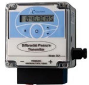
La presión medida se indica en display alfanumérico en unidades de ingeniería. Puede usarse conjuntamente con tubos pitot o elementos de flujo laminar. Admite configuración vía teclado integrado, con tecla independiente para cero. El FC0352 es ideal para aplicaciones industriales de medida, control y monitorización. Disponible en modelo intrínsecamente seguro (FC0354).
