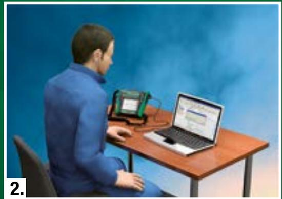
**Descarga de los procedimientos e instrucciones de calibración del software al MC6**
